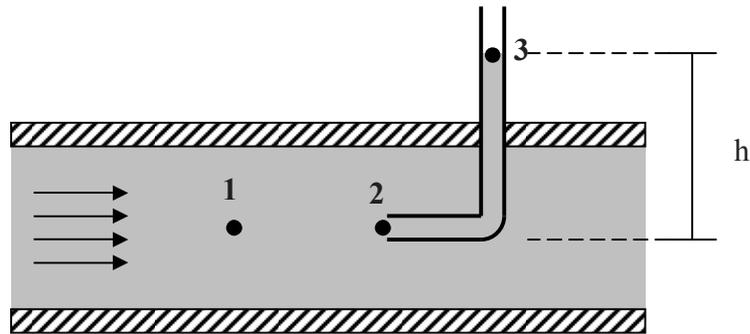
El tubo Pitot es un tubo transparente en L que se instala en una tubería por la que se mueve un fluido, por lo general un líquido, el cual llena el tubo hasta una altura  $h$  por efecto de la presión y de la velocidad del fluido.
