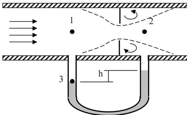
El principio del medidor de orificio es obligar al fluido a modificar el área transversal de flujo mediante una restricción brusca del mismo instalándole una placa circular perforada en el centro similar a una arandela. Así mismo se instalan tomas de presión a una distancia  $D$  "aguas arriba" y  $D/2$  "aguas abajo". De este mismo modo se puede aplicar la ecuación de Bernoulli entre los puntos 1 y 2:
