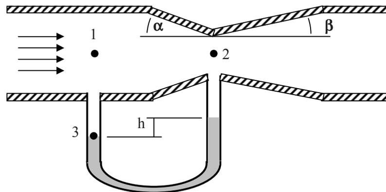
Es el más preciso (y más costoso) de los instrumentos basados en el cambio del área para medición de flujo. En el vénturi el cambio de área se produce de forma controlada mediante dos secciones cónicas en serie de reducción y expansión como se muestra en la figura. Esto hace que las perturbaciones en el flujo sean mucho menores, interfiriendo mucho menos en la medición.
