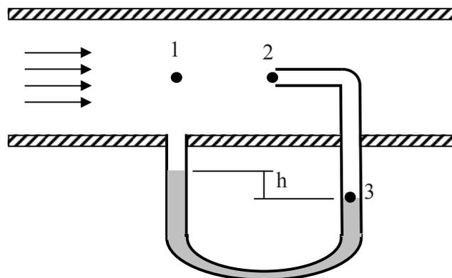
En la parte inferior del tubo hay un indicador, que puede ser mercurio, el cual permite calcular la diferencia de presiones entre los puntos 1 y 2, con lo cual es posible
